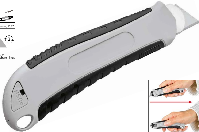
Klingentrückzug durch federbelastete Klinge
